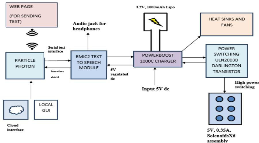
Fig. 2- Block Diagram
